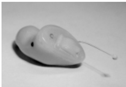
Hörselgångsapparat, helautomatisk utan kontroller med tråd för att kunna dra ut den ur örat.
