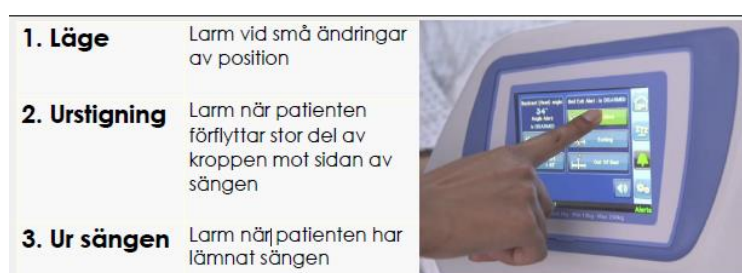
Figur 6. Larmpanelen på de smarta sängarna
